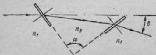
Рис. 2. Схематическое изображение хода луча внутри газоразрядной трубки
