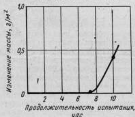
Рис. 2. Коррозионная стойкость тантала в щавелевой кислоте.
