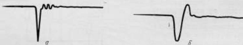
Рис. 6. Осциллограммы короткого импульса: а — без коррекции; б — с коррекцией включением индуктивности 2,5 мкГн.
