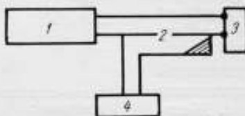
Блок-схема измерения переходного ослабления направленных ответвителей (1-й вариант).
