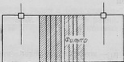
Рис. 4. Схема ионизационной камеры с цилиндрическими свинцовыми фильтрами для измерений в широком пучке \gamma -лучей
