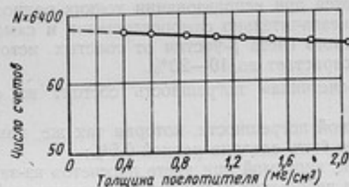
Рис. 11. Кривая поглощения и экстраполяции к нулевой толщине для \text{P}^{32}
